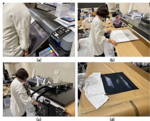
図8. 布地へのプリントの過程（a：プリンターからの出力、b：出力された結果を熱転写装置の布地の上に裏返しに置く、c：熱転写、d：Tシャツにプリントされた結果）
