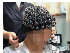
図8 fNIRS(島津製作所)の装着例
