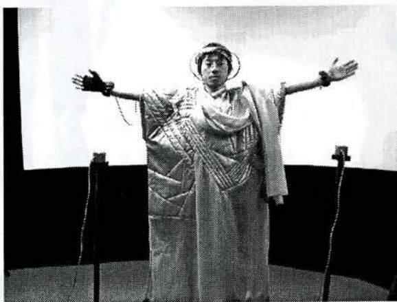
図8.12 「ロミオ」アバターを磁気センサーで制御する観客
